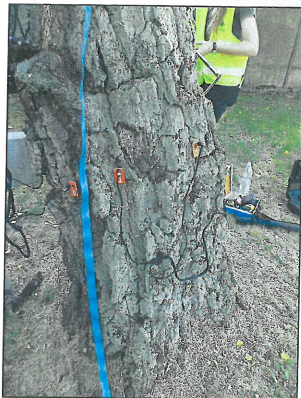
Zdj. 7 i 8. Badanie tomografem akustycznym
