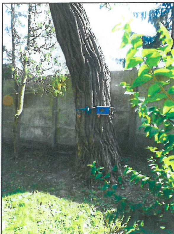
Zdj. 8. Badanie tomografem akustycznym
