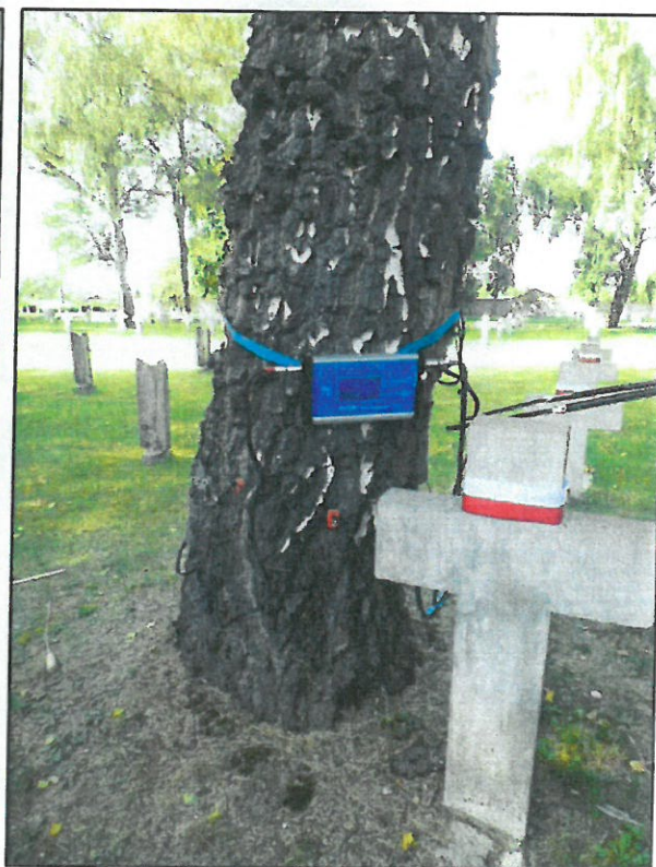
Zdj. 7 i 8. Badanie tomografem akustycznym
