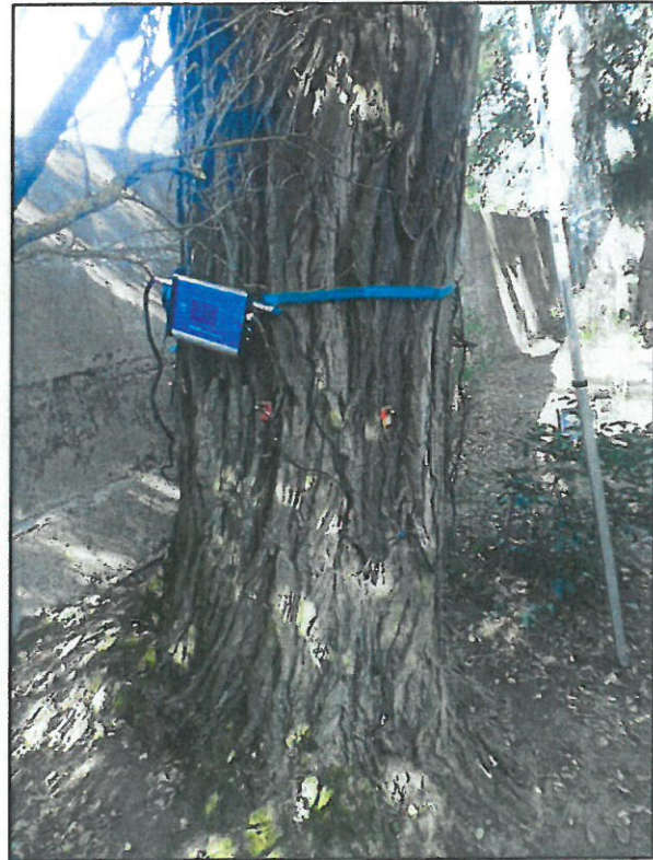
Zdj. 8. Badanie drzewa tomografem akustycznym
