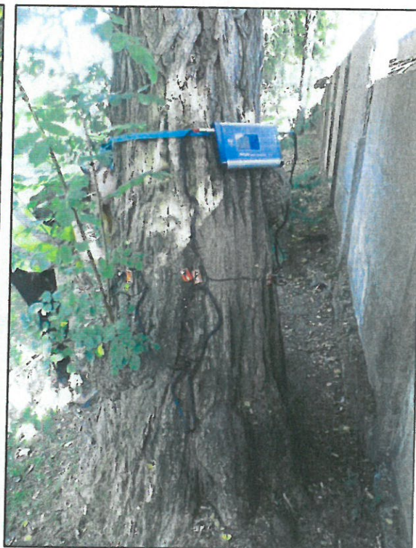
Zdj. 8. Badanie tomografem akustycznym
